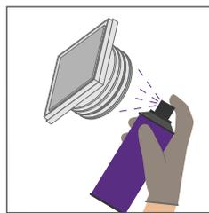
**3.** Rocía con lubricante en aerosol el tubo de salida acanalado.
