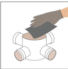
**1.** Haz un bisel o chaflán en el interior del caño de Ø 110 mm, para facilitar su colocación.
