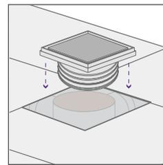
**4.** Encastra el tubo de salida acanalado de la rejilla para pileta de patio en el caño de Ø 110 mm hasta introducirlo en su interior.
