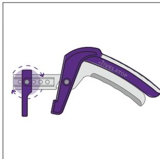
**3.** Afloja el tornillo de ajuste y desplaza el adaptador según el espesor del revestimiento. Guíate de la regla que contiene la pinza.
