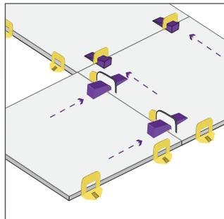
**2.** Inserta las cuñas en los clips autonivelantes colocados entre los cerámicos.
