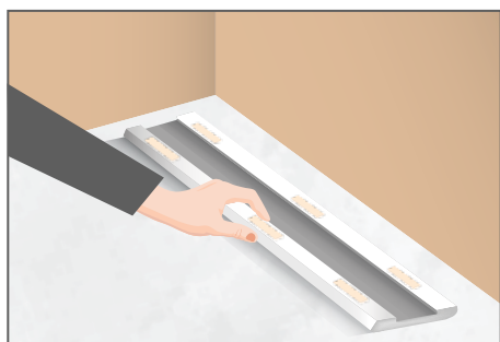
1. Adhiere cinta bifaz con cortes de 2 cm cada 40 cm y a no menos de 20 cm de los extremos del perfil.
