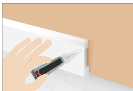
4. Utiliza pegamento instantáneo en las uniones de las juntas.
