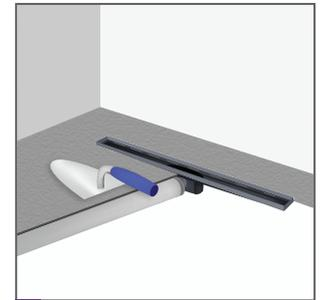
**8.** Extiende la mezcla de concreto hasta llegar al borde inferior de la base del desagüe creando una inclinación de mínimo 2% por metro lineal, en dirección a donde se instalará el desagüe. Si deseas, instala una membrana impermeabilizante siguiendo las instrucciones del fabricante.
