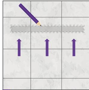
**3.** Presenta la canaleta y marca el contorno del desagüe en la superficie donde harás la instalación. La profundidad de la canaleta de 85 mm.
