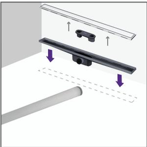
**5.** Conecta los caños de la red de desagüe al desagüe lineal utilizando pegamento en la conexión.
