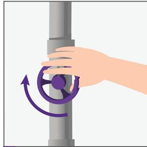
**2.** Cierra la abertura de evacuación del circuito de desagües antes de su montaje, para evitar que la suciedad producida durante las obras se introduzca en el conducto.
