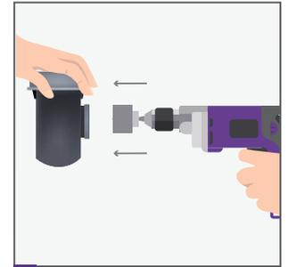
**4.** Realiza el orificio en la boca de salida correspondiente con una mecha copa de Ø35 mm o Ø36 mm.
