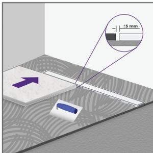
**10.** Instala los cerámicos dejando de 3 a 5 mm de junta con el borde de la canaleta. Para garantizar el flujo correcto del desagüe, los cerámicos deberán ubicarse a una altura de 1 mm mayor que la parte superior del desagüe. La instalación puede realizarse con cerámicos de 9 mm de altura. El sellado entre el suelo y el revestimiento debe ser elástico e impermeable.
