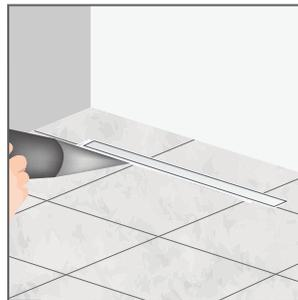
**11.** Aplica sellador de silicona en el perímetro del desagüe, cubriendo bien la junta, para asegurar una correcta fijación e impermeabilización.
