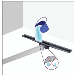
**7.** Realiza una prueba de estanqueidad vertiendo agua en la canaleta y verifica que el drenaje fluya.
