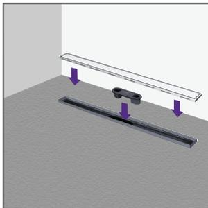
**9.** Coloca el sifón interno y la tapa del desagüe.
