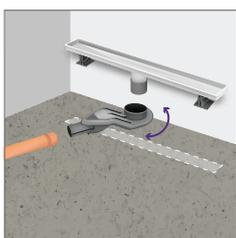
**4.2.** Conecta el caño de salida del desagüe en el cuello de goma del sifón ATRIM. Róttalo hasta la posición de instalación y conéctalo con la cañería de desagote.
