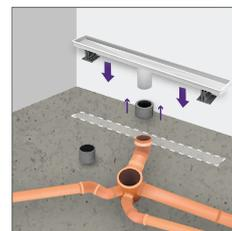
**4.1.** Reemplaza el adaptador de 40 mm por el de 50 mm en caso de tener cañería de ese diámetro o al utilizar el sifón 360° ATRIM.
