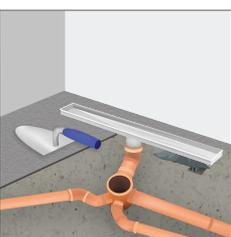
**8.** Extiende la mezcla de concreto hasta llegar a la base del desagüe, creando una inclinación de mínimo 2% por metro lineal en dirección a donde se instalará. Si deseas, coloca una membrana impermeabilizante siguiendo las instrucciones del fabricante.
