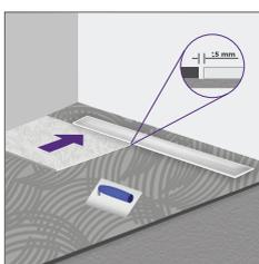
**11.** Coloca los cerámicos dejando 5 mm de junta con el borde del desagüe. Para garantizar el flujo correcto, los cerámicos deberán ubicarse a una altura mayor de 1 mm que la parte superior del desagüe. La instalación puede realizarse con revestimientos de hasta 16 mm de altura. Los cantos de los porcelanatos deben quedar biselados. El sellado entre el suelo y el revestimiento debe ser elástico e impermeable.
