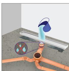
**7.** Realiza una prueba de estanqueidad vertiendo agua en la canaleta y verifica que el drenaje fluya.
