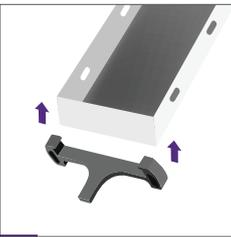
**10.** En caso de contar con un modelo 2 en 1, elige entre la tapa lisa o puedes invertirla y colocar en su interior el cerámico. Para ello, retira los sujetadores plásticos de la tapa utilizando la llave y colócalos en el lado opuesto de la misma; asegúrate que queden fijados correctamente. Para instalar el revestimiento, aplica una capa de mortero dentro del marco de la tapa para que el cerámico quede al ras.
