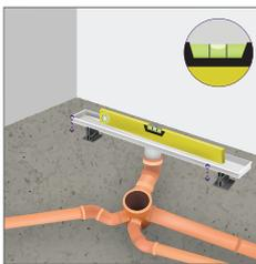
**5.** Utiliza la cinta bi-faz de las patas regulables para fijarlas al desagüe. Presenta el desagüe, regula la altura y verifica un buen apoyo en el suelo guiándote de la regla nivel.
