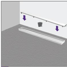
**9.** Inserta la válvula antirretorno con filtro de pelos y luego la tapa del desagüe.
