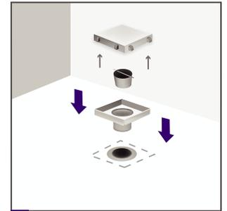
**4.** Conecta el tubo de salida de la base del desagüe con el tubo de desagüe de la ducha, sellando con la silicona impermeable.
