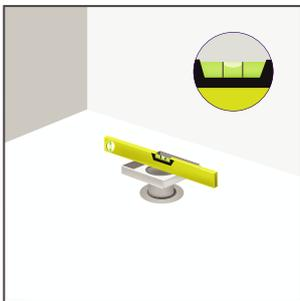
**5.** Presenta el desagüe nivelado en todas las direcciones mediante la regulación de los pies metálicos y guiándote de la regla nivel.
