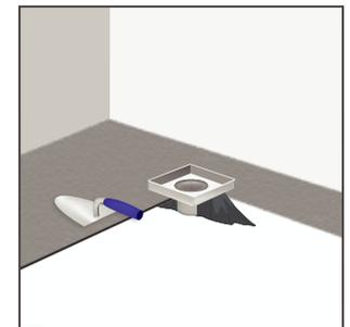
**8.** Extiende la mezcla de concreto hasta llegar al borde inferior de las alas laterales del desagüe creando una inclinación de mínimo 2% por metro lineal, en dirección a donde se instalará. Si deseas, instala una membrana impermeabilizante siguiendo las instrucciones del fabricante.
