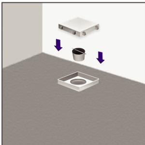
**9.** Coloca el filtro de pelos y la tapa del desagüe. Para el modelo 2 en 1, puedes elegir entre la tapa lisa preseleccionada o invertirla y colocarle el cerámico.
