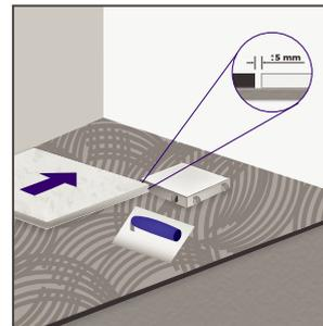
**11.** Coloca los cerámicos dejando +/- 5 mm de junta con el borde de la canaleta. Para garantizar el flujo correcto del desagüe, los cerámicos deberán ubicarse a una altura de 1 mm mayor que la parte superior del desagüe. La instalación puede realizarse con cerámicos de hasta 12 mm de altura. Los cantos de los porcelanatos deben quedar biselados. El sellado entre el suelo y el revestimiento debe ser elástico e impermeable.
