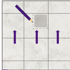
**3.** Presenta el desagüe y marca el contorno en la superficie donde harás la instalación. La profundidad del desagüe total es de 70 mm.
