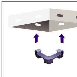
**10.** Retira los sujetadores de plástico utilizando la llave y colócalos en el lado opuesto. Asegúrate que éstos queden fijados a la tapa. Para la opción de cerámico: coloca una capa de mortero dentro del marco de la tapa para que el cerámico quede al ras de la misma.
