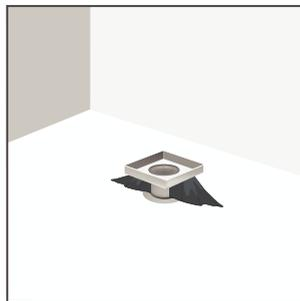
**6.** Vierte la mezcla de mortero en la parte inferior de la base del desagüe para dar soporte y asegurar la nivelación.
