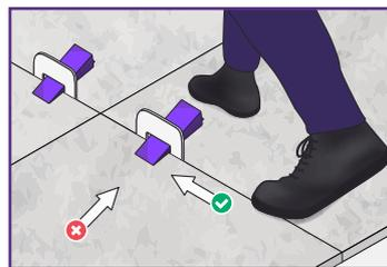
**5.** Una vez seco el adhesivo, retira las Cuñas golpeando los Clips Autonivelantes con un martillo de goma o pateándolos con zapatos de trabajo.
