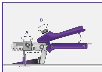
**3.2.** Ajusta el tornillo de presión. El ajuste correcto es aquel que permite ejercer la máxima presión.
