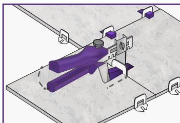
**4.** Sin modificar la posición de la Pinza Niveladora ajusta todas las Cuñas Niveladoras.
