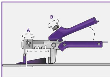
**3.1.** Afloja la mariposa o tornillo de ajuste y desplaza el cursor a la posición correcta, según el espesor de los porcelanatos y vuelve a ajustar la mariposa/tornillo.
