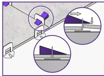
**2.** Inserta las Cuñas Niveladoras a través de los Clips Autonivelantes.
