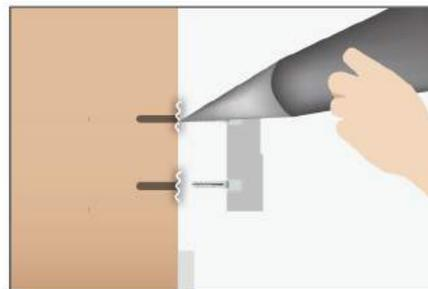
**5.** Corte los contramarcos y utilice el adhesivo ATRIM PRO-FIX® en el dorso de uno de los perfiles verticales. Adhiéralo a la pared/muro.
