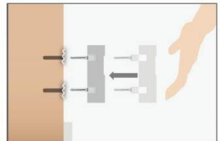
**6.** Presiónelo en varias áreas de la superficie contra la pared y el marco de la puerta para asegurar la fijación de los CLIPS EN T®. Recomendamos acompañar con una moderada cantidad de adhesivo ATRIM PRO-FIX®. Realice la misma operación con el lateral y luego con el contramarco superior.
