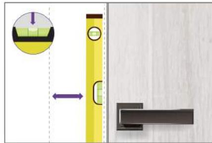
**2.** Ayúdese con el nivel de mano para corroborar que la posición de las líneas sean correctas, de esta manera asegura que la posición de los contramarcos quede nivelada con la línea de la puerta. Retire el envoltorio plástico de los contramarcos comprobando que no se encuentren dañados.
