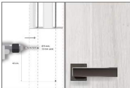
**4.** Coloque en el dorso de los contramarcos al menos una unidad de clip cada 40 cm lineales de perfil. Realice orificios de Ø5 mm x 10 mm en la pared/muro centrados respecto a la posición de los CLIPS EN T® colocados.
