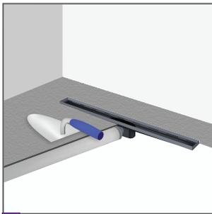
**9.** Extiende la mezcla de concreto hasta llegar al borde inferior de la base del desagüe creando una inclinación de mínimo 2% por metro lineal, en dirección a donde se instalará el desagüe. Si deseas, instala una membrana impermeabilizante siguiendo las instrucciones del fabricante.
