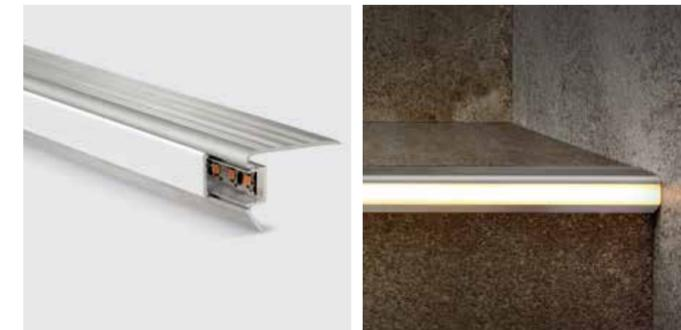
Resalta y da visibilidad a los cantos de los escalones. Se coloca luego de instalado el revestimiento. Su cavidad para alojar la tira de LED está orientada hacia el frente, generando una iluminación más direccionada. La superficie de pisada de 45 mm es ideal para zonas de alto tránsito, como cines, teatros, etc. Cuenta con terminales.
