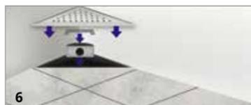
6 Remueva los residuos que se encuentren en la Canaleta. Coloque el sifón y la rejilla plástica. Retire el film protector y coloque la tapa.
