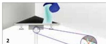
2 Conecte el desagüe a la cañería presionando la pieza de reducción (40DM) sobre el Conector. Utilice sellador del lado del desagüe de 50 DM conectando a la cañería.
