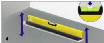
4 La canaleta debe quedar nivelada durante el relleno de la carpeta. Compruebe que exista una mínima inclinación hacia el desagüe.
