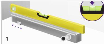
1 Coloque el desagüe en la entrada, centro o en el lateral de la ducha, nivelando en todas las direcciones con el soporte de ajuste. La profundidad de la canaleta es de 85 mm.
