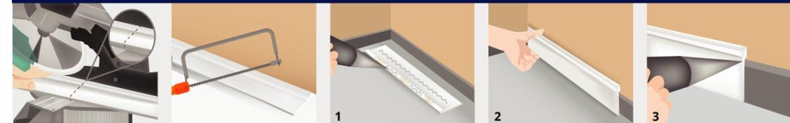
Para cortar los zócalos utilice una sierra manual o mecánica con disco de diente fino. No se recomienda el uso de discos de carbono ya que podrían dañar los zócalos.
