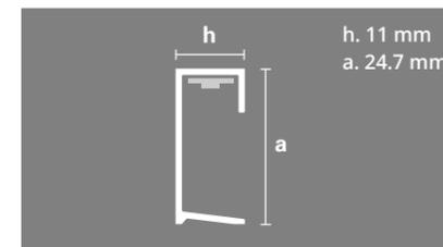
Este perfil versátil puede colocarse como listello decorativo, terminación superior en paredes o zócalo. Su cavidad interior permite alojar una tira de LED, generando un efecto difusor y homogéneo y según su posición consigue efectos de luz directa o indirecta. Se instala junto con el revestimiento. Provisto de terminales.
