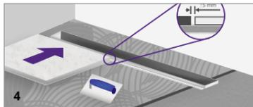
4 Para el flujo correcto del desagüe deberán colocarse los porcelanatos a una altura de 1 mm mayor que la parte superior, y dejando +/- 5 mm de junta con el borde del desagüe.
