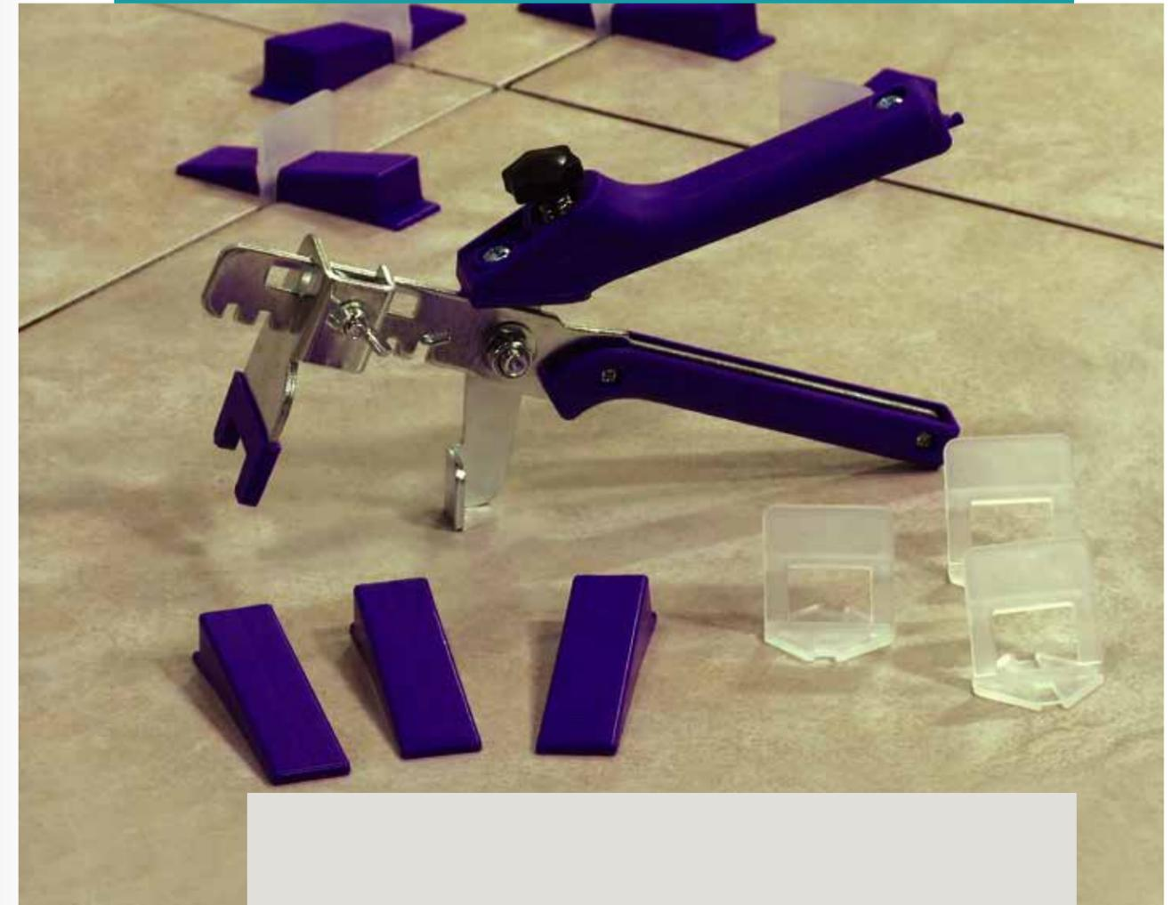
Crucetas, niveladores y pinza para realizar una correcta colocación de los revestimientos.
