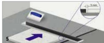
5 Utilice pegamento impermeable y coloque cerámicos dejando +/- 5 mm de junta con el borde de la Canaleta.
