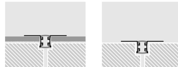
Puede instalarse en pisos de microcemento o cemento alisado, mármoles, piedra, también en muros y cielorrasos.
