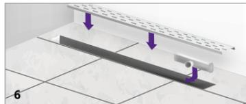
6 Remueva los residuos que se encuentren en la Canaleta. Coloque el sifón. Retire el film protector y coloque la tapa.
