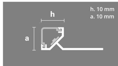
Terminación diseñada para acentuar el protagonismo de bordes y esquinas logrando un efecto único, debido a su difusor semi curvo que emite un haz de luz de manera bidireccional. Cuenta con un difusor de policarbonato y terminales plásticos.
