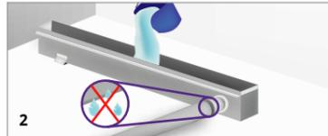
2 Adhiera el conector a la red de desagüe utilizando pegamento en la conexión. Realice prueba de estanqueidad vertiendo agua en la canaleta y verifique que el drenaje fluya.
