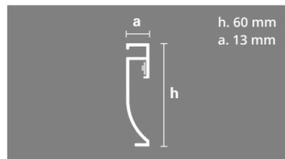
Diseñado especialmente para interiores vanguardistas, este perfil empotrable de 60 mm de altura, cuenta con un canal para la tira de LED. Su diseño semi curvo permite iluminar, dando calidez y creando efectos cromáticos, que enriquecen y definen los espacios. Cuenta con terminales.
