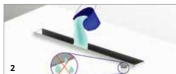
2 Realice prueba de estanqueidad vertiendo agua en la canaleta y verifique que el drenaje fluya.
