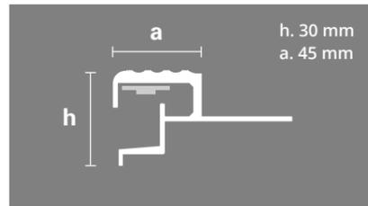
Perfil antideslizante para decorar, iluminar y otorgar seguridad al canto de los escalones. Su cavidad interior permite la instalación de una tira LED sin necesidad de incorporar difusor. Debe colocarse junto al revestimiento y es apto para áreas de alto tránsito. Cuenta con terminales.
