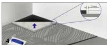
4 Utilice pegamento impermeable y coloque cerámicos dejando +/- 5 mm de junta con el borde de la Canaleta.
