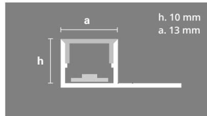
Perfil que permite diseñar líneas rectas en paredes o bordes de columnas. Su tapa difusora genera un efecto lumínico continuo y homogéneo. Provisto de terminales y difusor de policarbonato.
