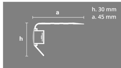
Resalta y da visibilidad a los cantos de los escalones. Se coloca luego de instalado el revestimiento. Su cavidad para alojar la tira de LED está orientada hacia el frente, que está cubierto por un acrílico de alto impacto, generando una iluminación más direccionada. La superficie de pisada de 45 mm es ideal para zonas de alto tránsito, como cines, teatros, etc. Cuenta con terminales.
