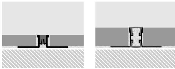
Absorben el movimiento producido por la dilatación de los materiales. Las pestañas laterales metálicas del perfil tienen un buen agarre bajo el revestimiento cerámico y acompañan los movimientos de compresión y expansión. No deben elevarse por encima del nivel de cobertura de superficie del revestimiento.
